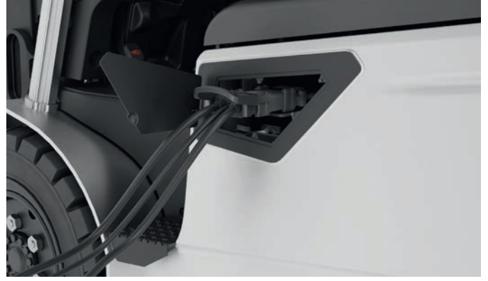
Şarj işlemi artık daha kolay: Hızlı şarj için yandan erişimli, bakım gerektirmeyen lityum iyon versiyon
