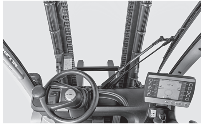
Olağanüstü ileri görüş için teleskopik asansör
