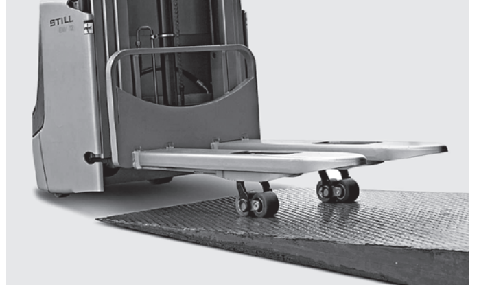
Rampalar için ideal: EXV, isteğe bağlı ilk kaldırma mekanizması sayesinde rampalara kolayca tırmanır
